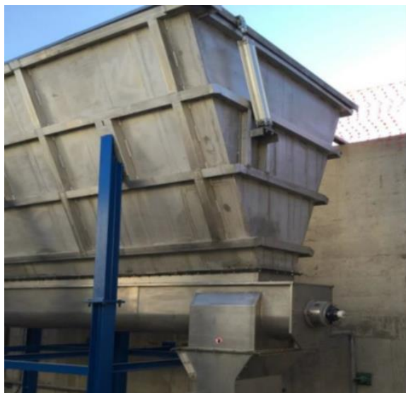
Ilustración 10 – Tolva de recepción de residuos sólidos SANDACH.
