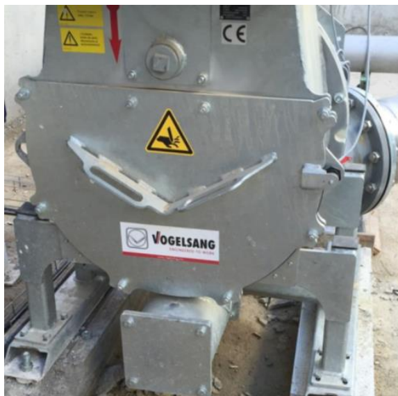
Ilustración 12 – Dilacerador residuos sólidos SANDACH.
