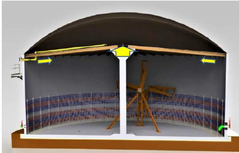
Ilustración 18 – Detalle del techo interior de madera. Digestores anaerobios tipo COCCU (Schmack Biogas Srl).
